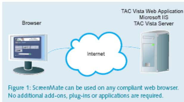
TAC VISTA® V SCREENMATE permette a tutti gli utenti, che non hanno conoscenze specifiche dei sistemi di building automation, di controllare ed integrare con alcune parti dell'impianto tramite un web browser standard. Le informazioni richieste sono presentate in formato web direttamente sul proprio computer.
